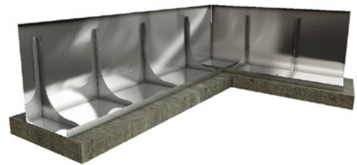
Außenecke: Winkelfuß einschneiden und Umbiegen.
