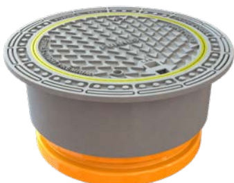
600 flytande ram till Wavin Tegra 600 stigarör (Monteras utvändigt), PREMIUM lock, slitsad packning, lås och tätt spetthål
