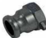
Hankoppling A med invändig cylindrisk rörgänga. Teflontätning i botten av gängen
