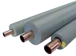
Isolering Tubolit Material: Expande- rande polyeten med slutna celler. Temperaturområde: -45 °C – +100 °C. Längd: 2 m
