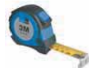
Mätband stål Novipro Magnetisk ändhake, enkelt för en person att mäta. Tåligt hölje i ABS-plast. Stötskydd i gummi skyddar höljet och bromsknappe
