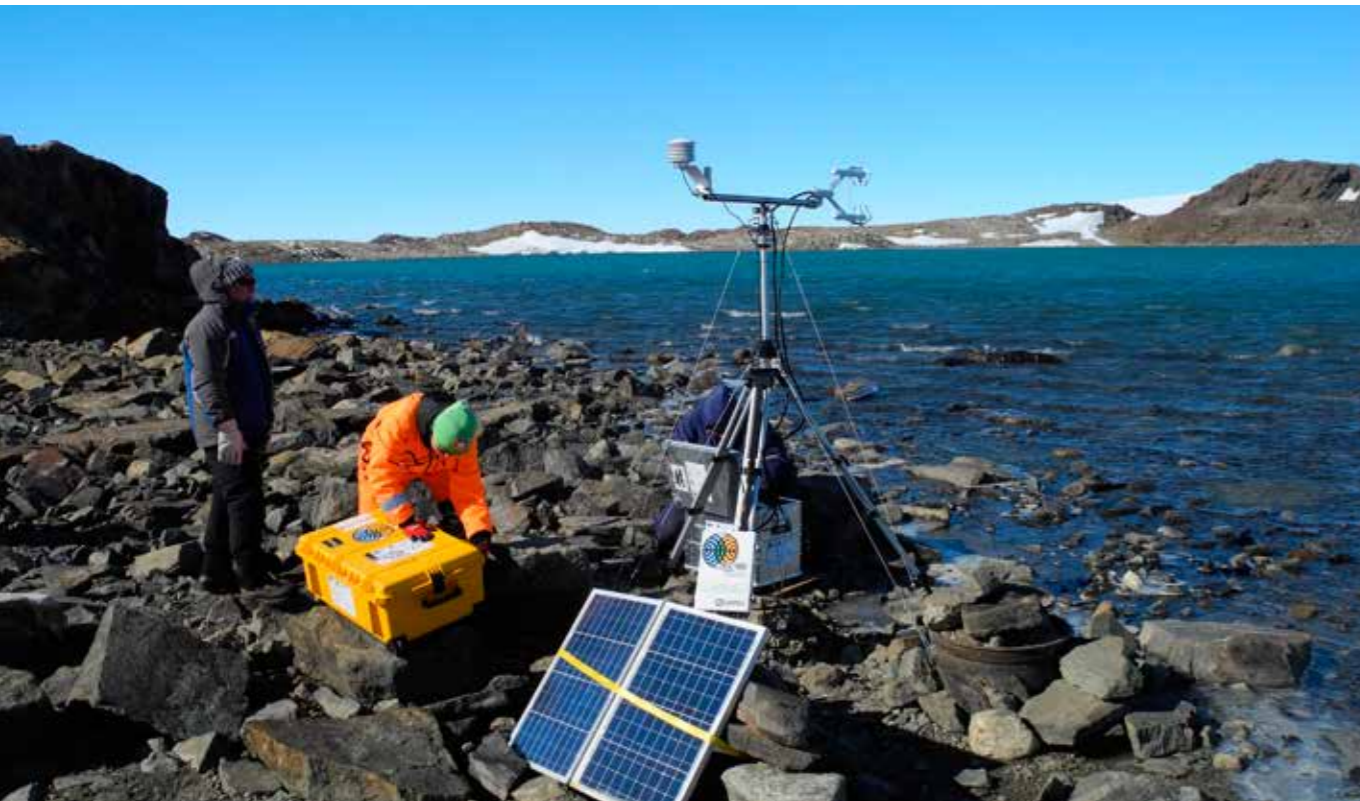
IRGASON kaasuanalysaattorin asennus Priyadarshinin järvellä. IRGASON deployment for fluxes measurements on the lake Priyadarshini. Kuva | Photo: Dmitry Emelyanov.
