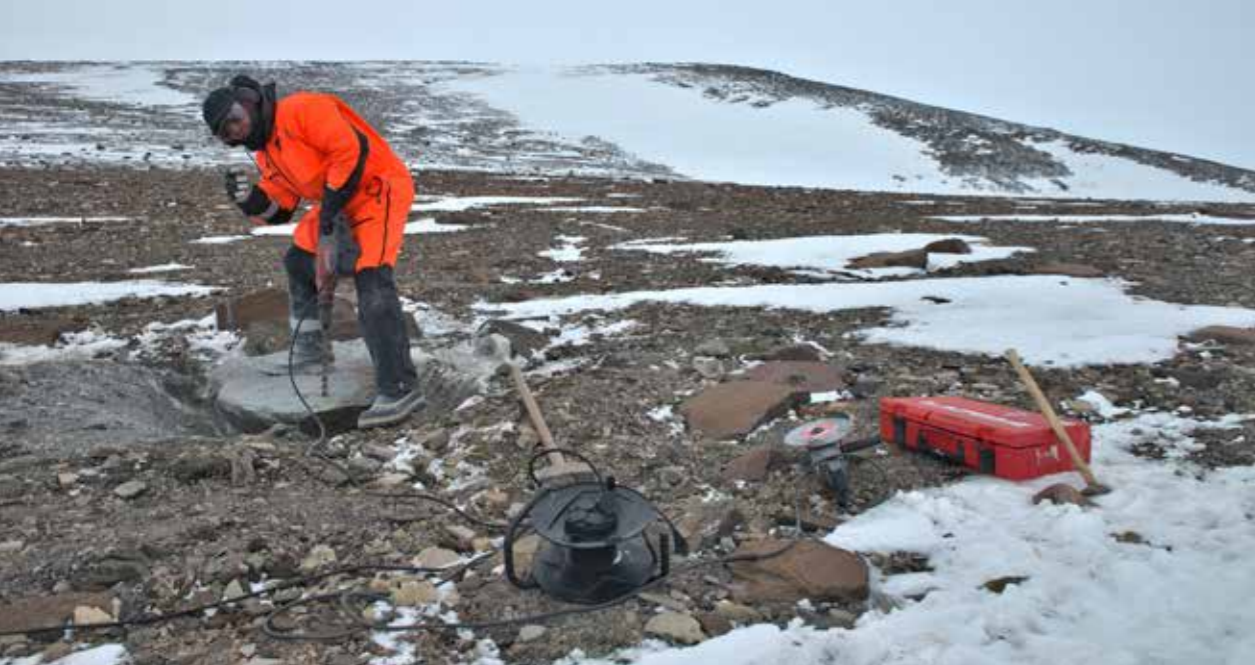
Arto Luttinen keräämässä kiviläytettä poravasaran avulla pikriittilohkareen kulmasta. Arto Luttinen collecting rock samples with an hammer drill from picrite. Kuva | Photo: Sanni Turunen
