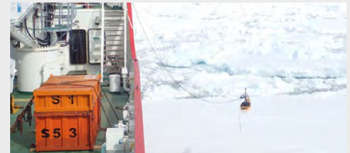
Jään paksuutta mittaava sähkömagneettinen laite keltaisen kajakin sisällä. Kuva: Jaakko Seppänen
