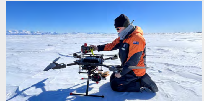
Mittausdrooni varustettiin ylös- ja alaspäin suunnatuilla Kipp ja Zonen CM4 -pyranometreillä ja Ocean Opticsin STS VIS- ja NIR-spektroradiometreillä säteilyn laajakaista- ja albedomittauksia varten. Kuva: J. Martin
