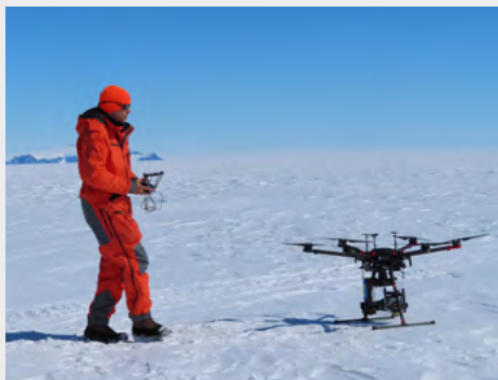
Aleksi valmiste- lee säteilydroonia mittauksia varten. Droonin kyydissä on hyperspektrikamera ja laajakaistainen säteilyanturi. Kuva: Leppänen/ FINNARP
