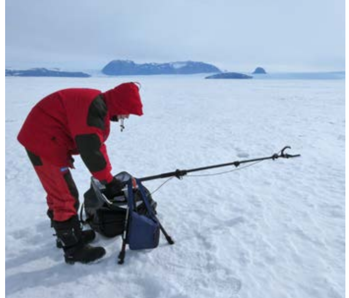
Anja Mödl mittaamassa pinnan spektristä albedoa transektin varrella kannettavalla ASD FieldSpec -radiometrillä.
