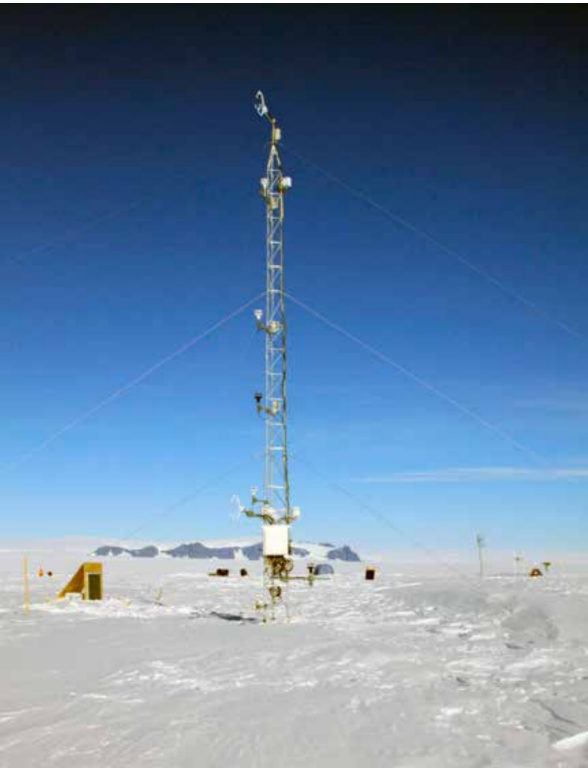
10 metriä korkea säämast. Taustalla näkyy muita automaattisia mittalaitteita ja Plogen-nunatak. 10-meter-high weather mast. On the background there are other automatic instruments and Plogen nunatak. Kuva | Photo: Juho Vehviläinen
