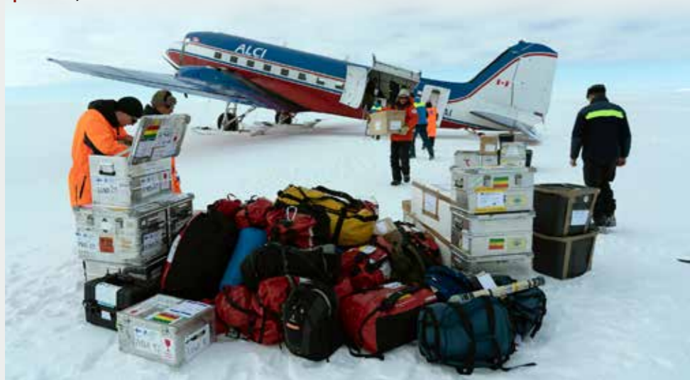
Rahdin purkua Basler BT-67 suksilentokoneesta Basenin jäätiköllä. Offloading cargo from ski-equipped Basler BT-67 on the glacier nearby Basen.
