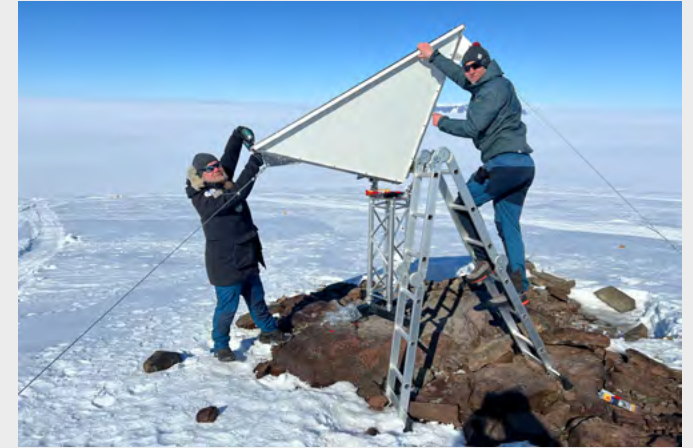
Arttu ja Jyri asentavat SAR heijastinta. Kuva: FINNARP
