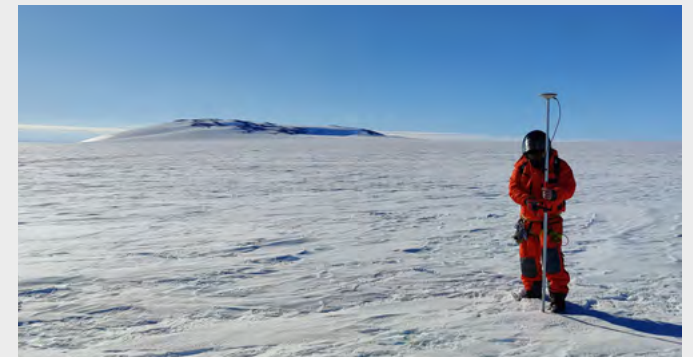
Jyri mittaa jäätikön korkeutta RTK-GPS:llä. Kuva: Arttu Raja-Halli
