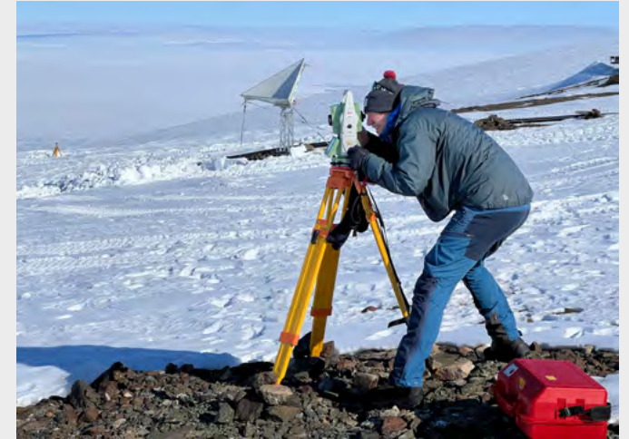
Arttu mittaa heijastinten paikallissidoksia. Kuva: Jyri Näränen
