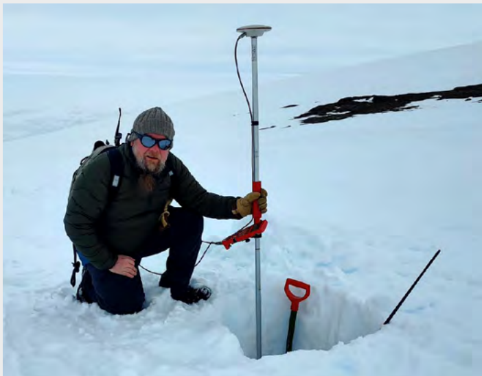
Geodeettisia mittauksia (RTK-GPS) Basenin jäätiköllä.
