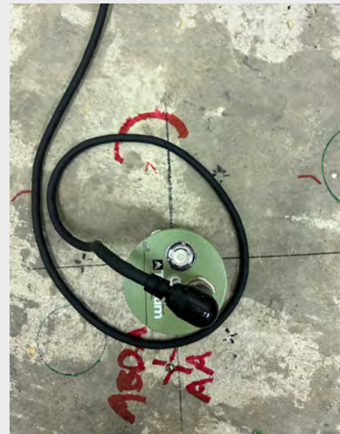
Trillium Compact 120s seismometri. Kuva: Priit Tisler / FINNARP
