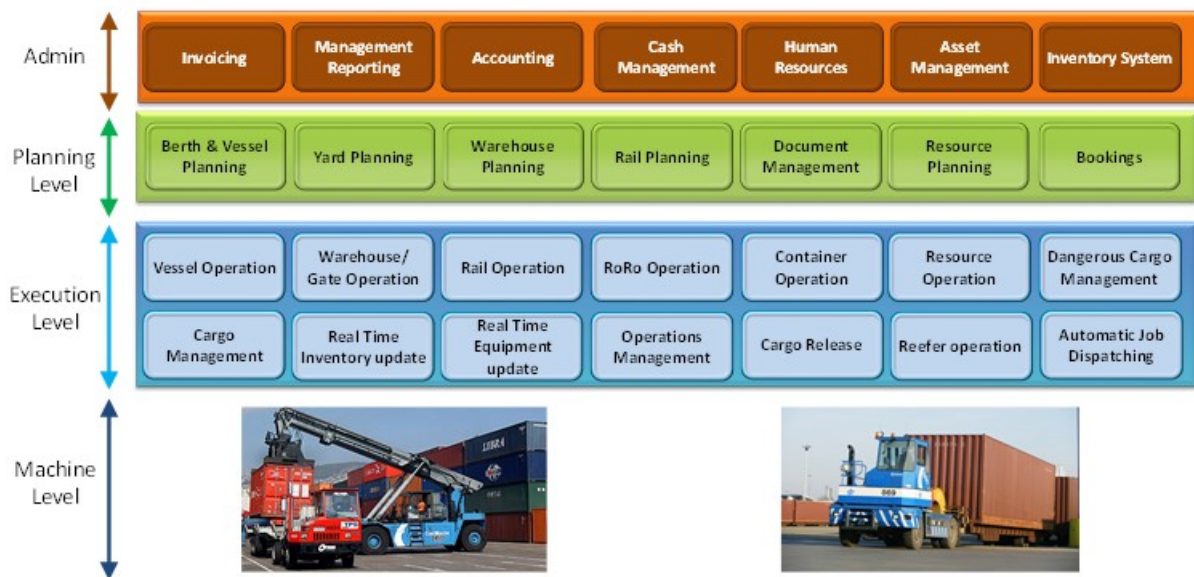
Figur 5: Eksempel på modulær oppbygning av TOS
