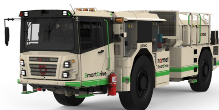
Utimec LF 600 Transmixer SD con una capacidad practica para transportar 5,6 m³.
