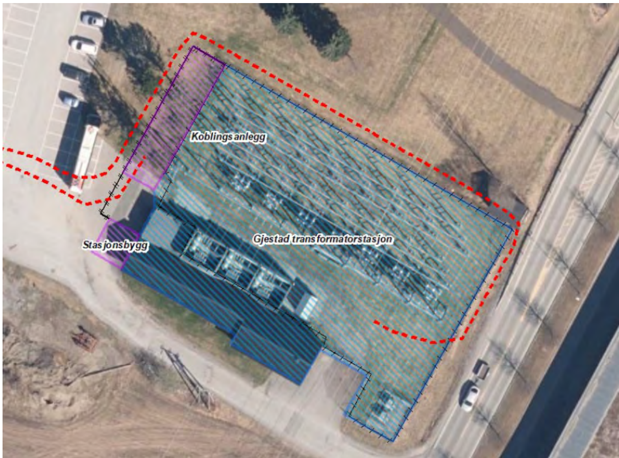
Figur 2: Oversikt over Gjestad transformatorstasjon. Utvidelse av anleggene vises med lilla farge.
