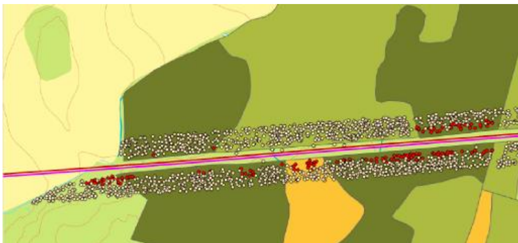
Figur 8: Røde prikker er trær som kan falle på ledningen, mens lyse prikker er trær som ikke kan falle på ledningen.
