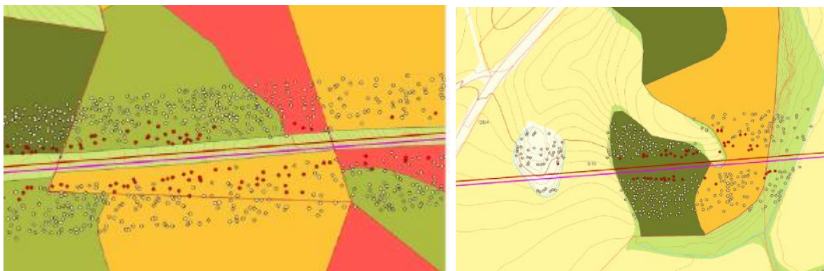
Figur 9: Røde prikker er trær som kan falle på ledningen, mens lyse prikker er trær som ikke kan falle på ledningen.
