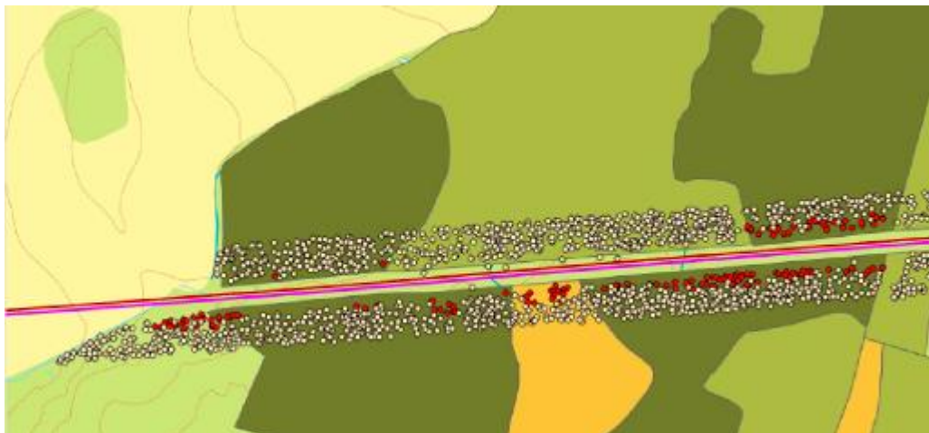
Figur 5: Kartutsnitt som viser fare for trefall. Trær som vurderes å utgjøre en fare for ledningen er markert med rød farge.
