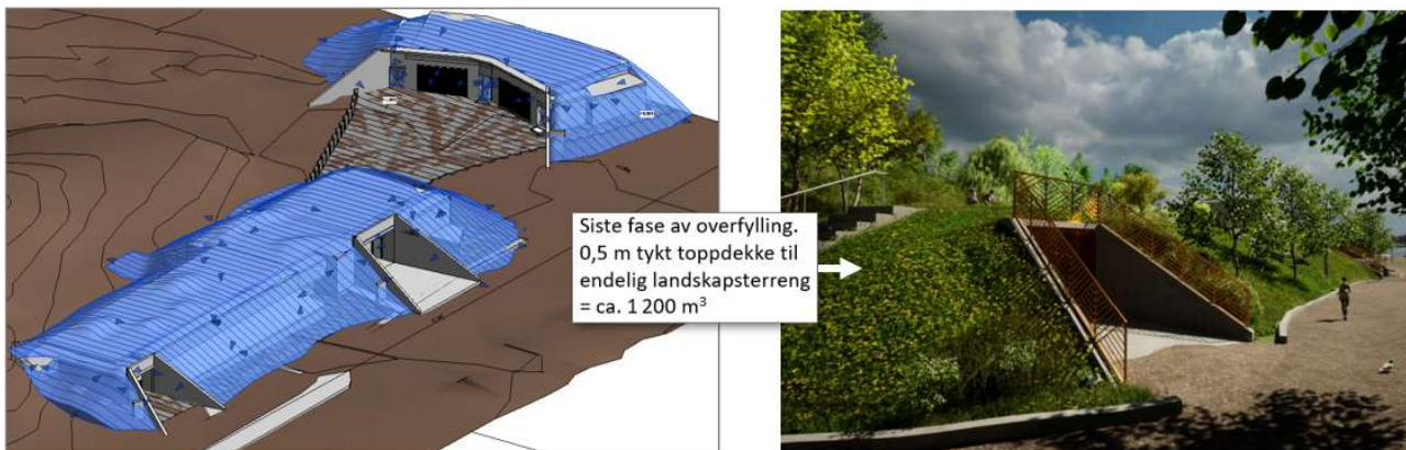
Figur 9: Overfylling til 0,5 m under endelig terrengnivå, samt topp jordlag (ca. 1 200 m 3 ) opp til endelig terrengnivå
