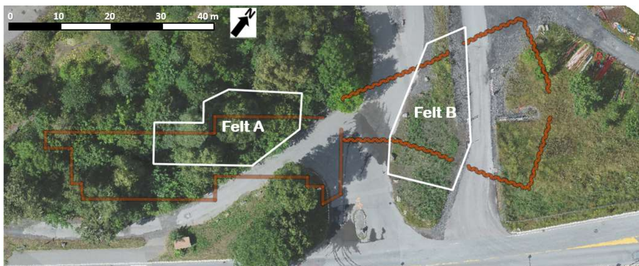
Figur 26: De to delområdene med lett forurensete masser (Felt A og Felt B) skal graves ut i egen arbeidsoperasjon.
