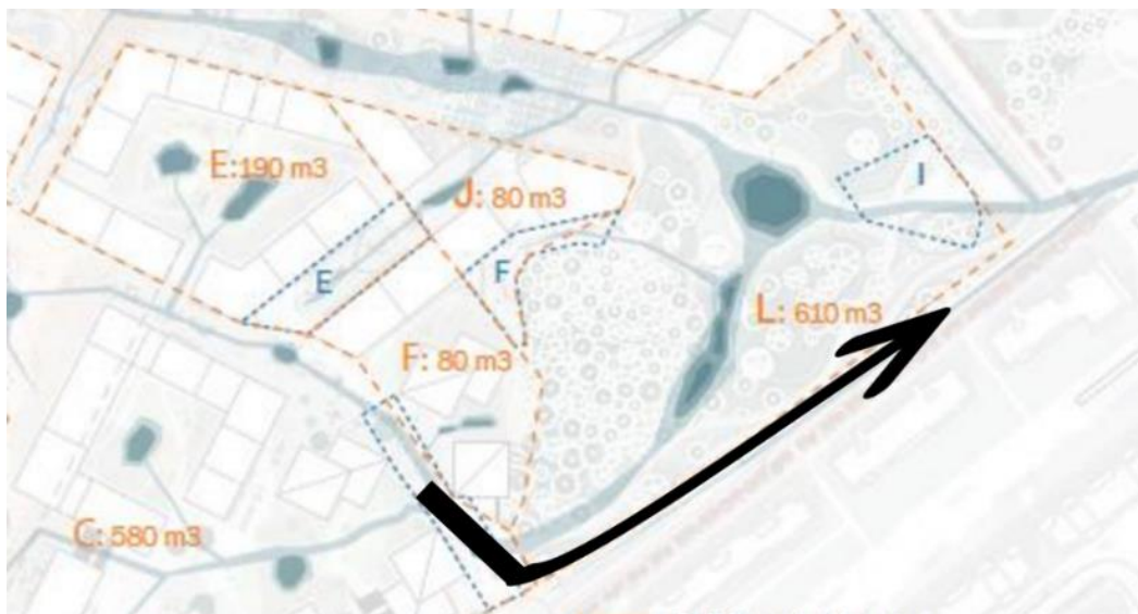
Figur 3-1. Illustrasjon. Håndtering av overvann fra omkringliggende felt.
