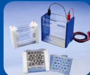
Elektrophoresekammer mit optionalem Tankblotmodul
