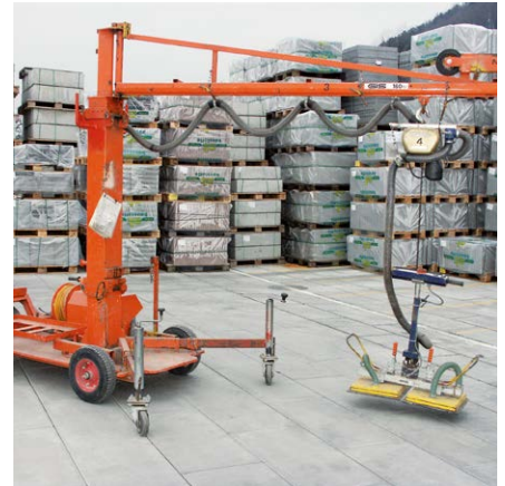
PLATTEX Plattenverlegegerät bis 125 kg
