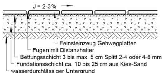
Bild 3: Aufbau des Plattenbelages über einer Foundationsschicht
