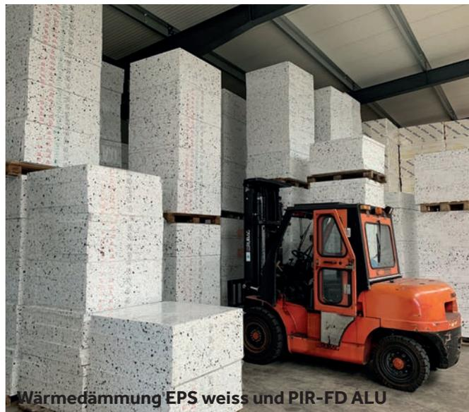
**Wärmedämmung EPS weiss und PIR-FD ALU**
