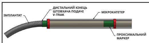
Рисунки 4 – Розташування маркерних смужок для від'єднання
