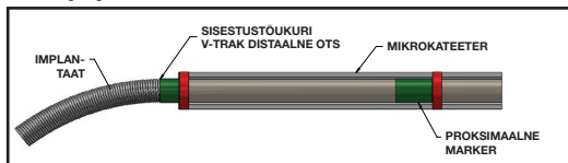
Joonis 4. Markerriba asend eraldamiseks
