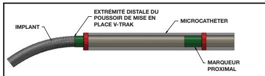
Figure 4 - Position des marqueurs pour le détachement
