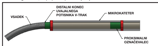
Slika 4 – Položaj označevalnih trakov za ločevanje
