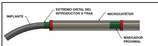
Figura 4: posición de las bandas marcadoras para la separación
