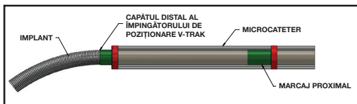
Figura 4 – Poziția benzilor de marcaj pentru detașare
