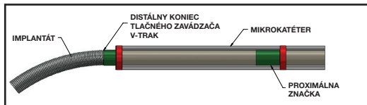
Obrázok 4 – Poloha pružových značiek na odpojenie
