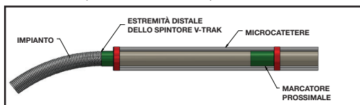
Figura 4 - Posizione delle bande di marcatura per il distacco
