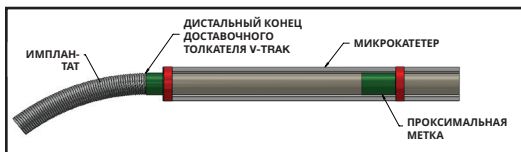
Рисунок 4. Расположение кольцевых меток для отсоединения
