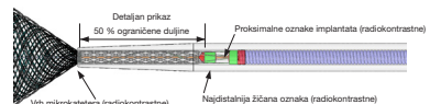
Slika 8. Korak 16. Uređaj FRED Jr. može se ponovno uhvatiti i premjestiti ako još nije u potpunosti postavljen.
