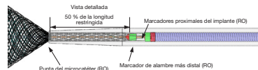
[Figura 8. Paso 16. El dispositivo FRED Jr. puede ser recapturado y reposicionado si aún no está completamente desplegado.]
