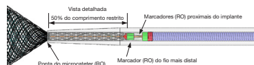
[Figura 8, Passo 16. O dispositivo FRED Jr. pode ser recapturado e reposicionado se ainda não estiver totalmente desdobrado]
