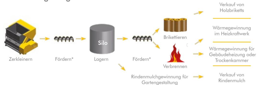
\*) Fördern mit Förderschnecken, Förderbändern, Kratzkettenförderern, Absauganlagen, ...
