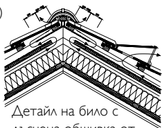
Детайл на било с дъсчана обшивка
