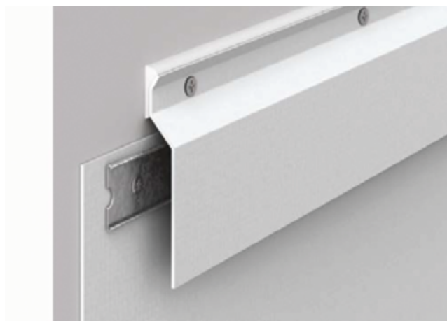
Figura 11. Membrana sujeita mediante barreira de ancoragem e perfil metálico pressurizado.
