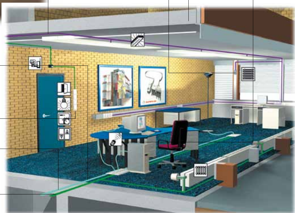
Lattakaapeli Power 5x10 jossa Power 5x10 -sovitin, lähtö virran lähtöpiiri lattakaapelille Power 5x10 mm 2 esim. esikoottuna lattiarasioiden ja lähtöpiirin sulakkeen kanssa
