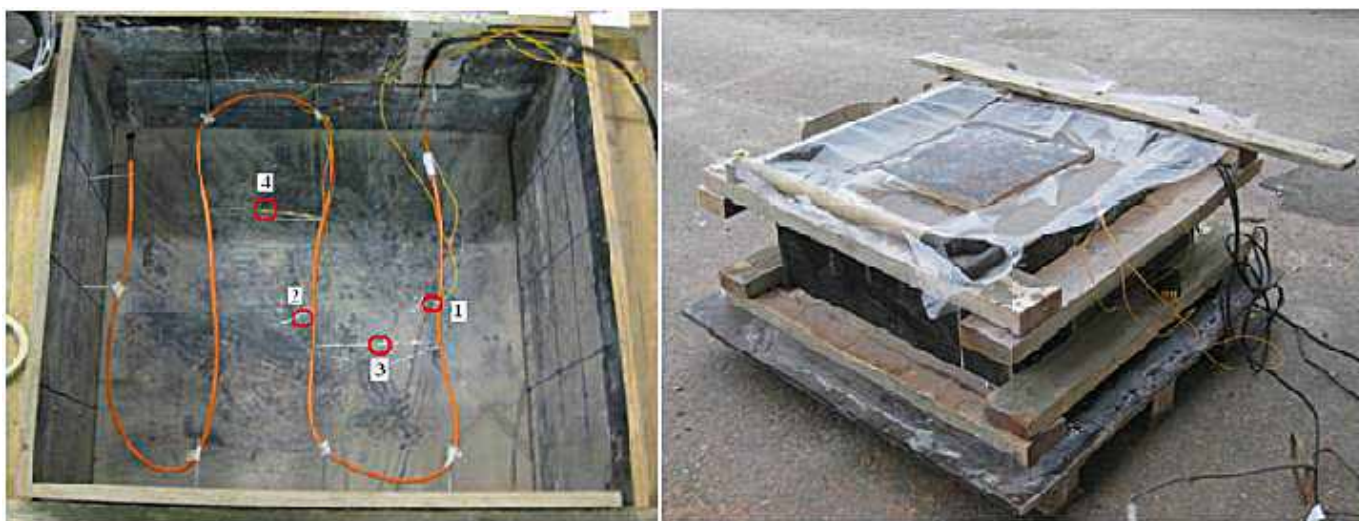
Kuva 13. Lämmityskaapeloinnin sijoitus muottiin (vasemmalla); kappaleen säilytys pakkassäissä kaksi vuorokautta (oikealla).
