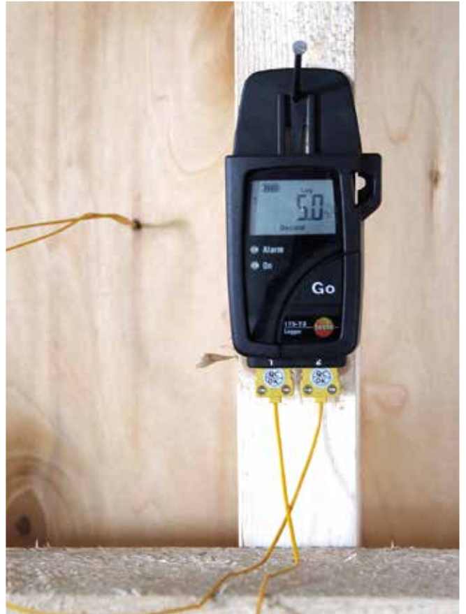
Kuva 19 Lämpötilan mittauslaite (loggeri) edestä
