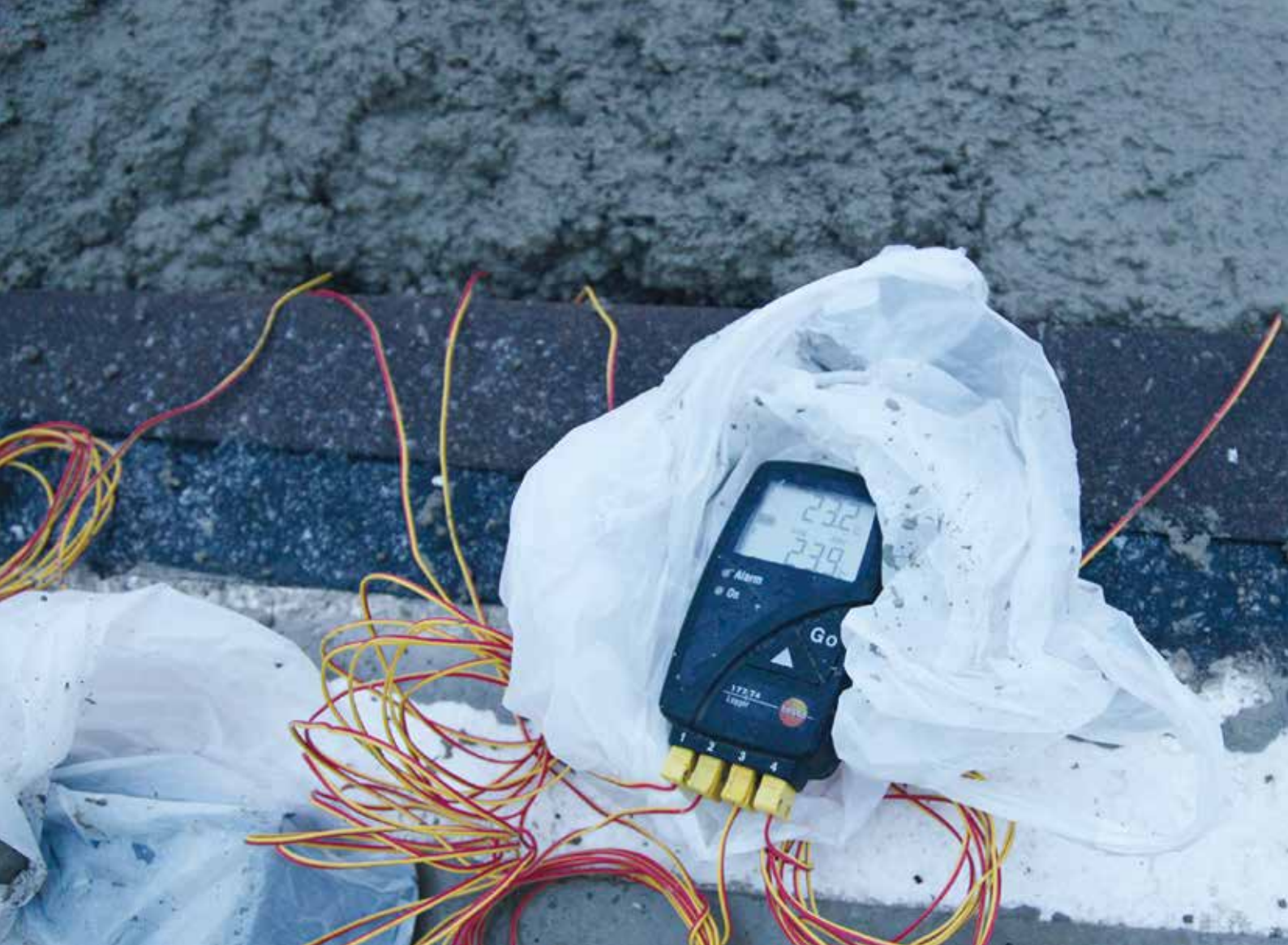
Kuva 3 Lämpötilan seurantalaite, 4-kanavainen datalogger
