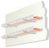
Seinä ilman kierretankoja
