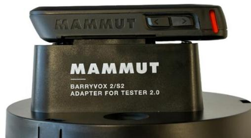
Abbildung 2 Aufstecken des Barryvox auf den Adapter
