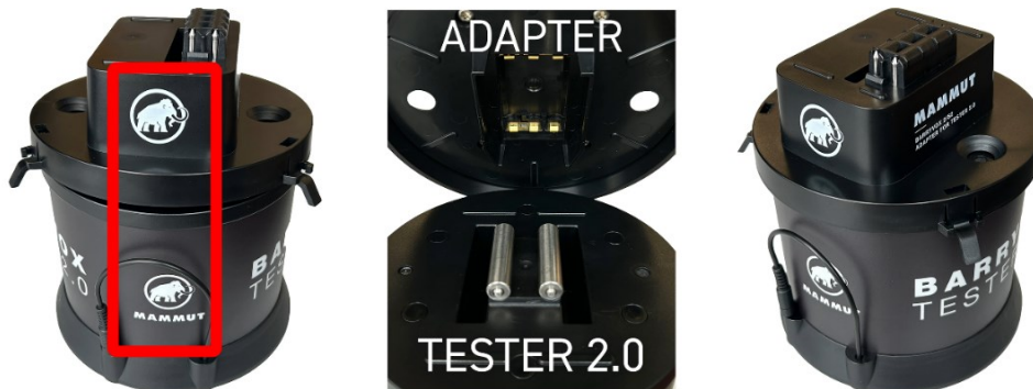
Abbildung 1 Anschliessen des Adapters and den Tester 2.0
