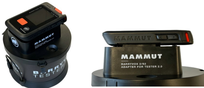
Abbildung 2 Aufstecken des Barryvox auf den Adapter
