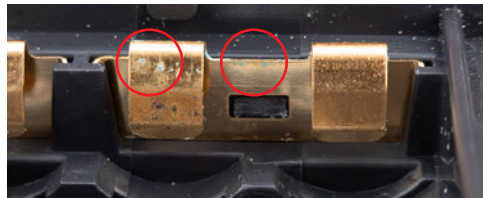
Batterikontakter med tydliga tecken på läckande batterier, vilket kräver att kontakterna byts.
