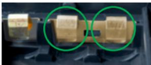
Contacto de baterías con un nivel muy bajo y aceptable de contaminación. Este tipo de contactos no deben ser reemplazados por el momento.
