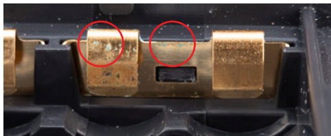
Контакт с явными признаками протечки батареи, требующий замены контакта.
