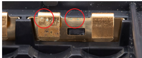
Contatto della batteria con chiari segni di perdite dalle batterie che richiedono la sostituzione del contatto.
