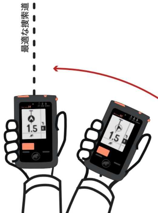
ファインサーチで矩形プロービングのアイコンが表示されたならば、要救助者に最も接近している周辺であり、雪崩トランシーバーでの搜索を一旦止め、プロービングをすることをお勧めします。もし、ファインサーチで距離表示が大きければ、精度が求められる十字法の搜索により範囲を狭めることができ、2、3回ほど十字法を実施してください。機器はこれらの動きとデータを集約し、適切な情報を表示しようと試みます。そして要救助者に最も接近した時、次の手順であるピンポイントングをするよう促すため、プロービングのアイコンが表示されます。埋没者を探せるのはプローブのみだと言うことを心に留めてください。
