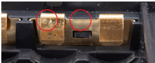
電池の液漏れにより、明らかな腐食部分が板バネ端子や銅板に見受けられるならば、端子全体の新しい交換が必要となります。
