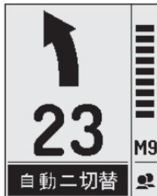
設定が埋没者の距離に対しあまりにも高感度や低感度ならば、距離表示や矢印は信頼度がなく、数値が点滅します。このように数値の点滅の状況下では、右の黒色バーの上部に2重矢印(↕または↕)が表示され、感度ボリュームの調整を促します。
