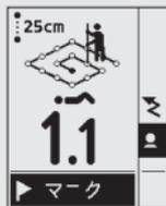
▶ 距離表示を参考にした上で、プロービングで要救助者を見つけることを「プローブヒット」と呼び、雪の中にプローブを挿したまま、掘り出しを敢行してください。
