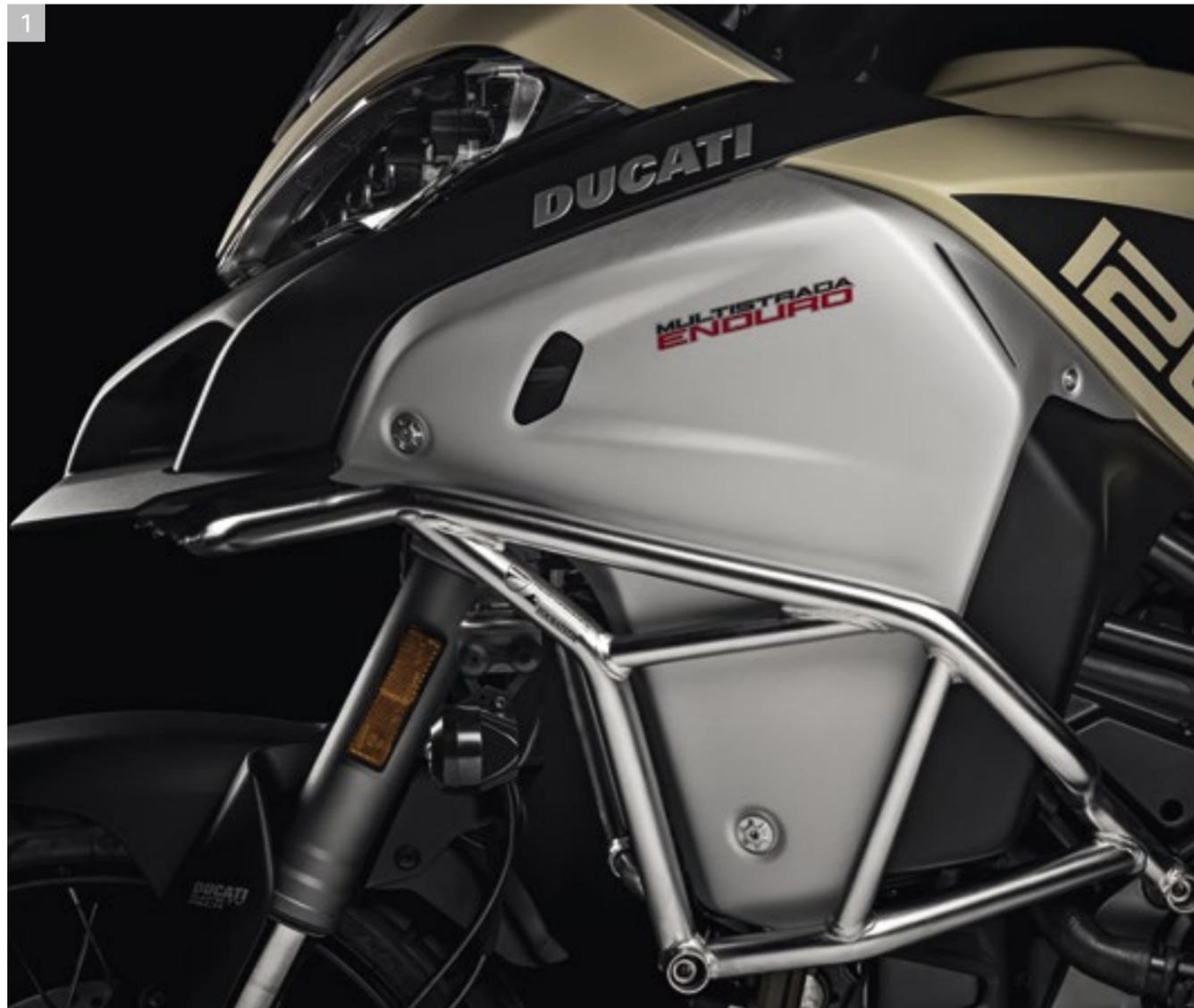
1 Seitliche Tankschutzelemente aus Stahlrohren
