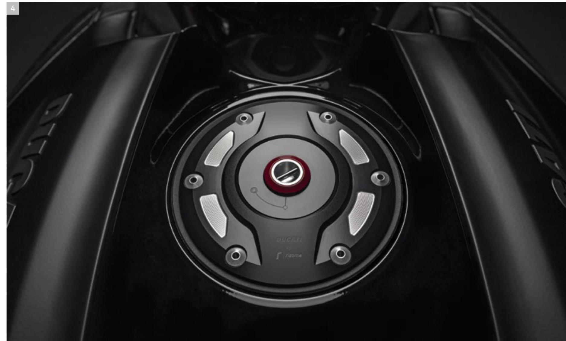
4 Tankverschluss aus Aluminium, aus dem Vollen gearbeitet
