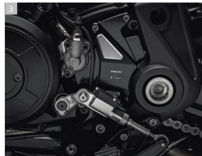
3 Ritzelabdeckung aus Aluminium, aus dem Vollen gearbeitet
