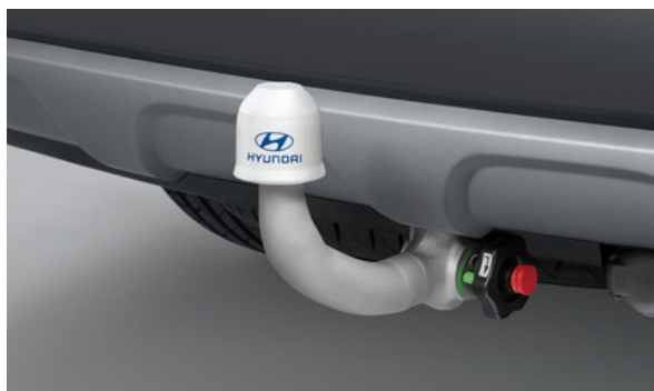
Dragkrok, avtagbar. Konstruerad av höghållfasthetsstål med ett låssystem som gör den enkel att montera på ett säkert sätt. Kan förvaras i bilen när den inte används. 2W281ADE04
