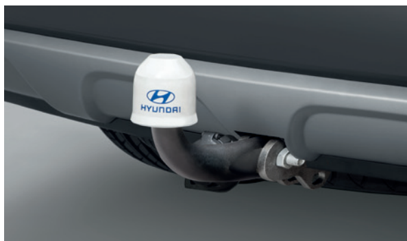
Dragkrok, fast. Finns monterad när du behöver den. Tillverkad i höghållfasthetsstål. Artikelnummer ej klar vid tryck av denna broschyr.
