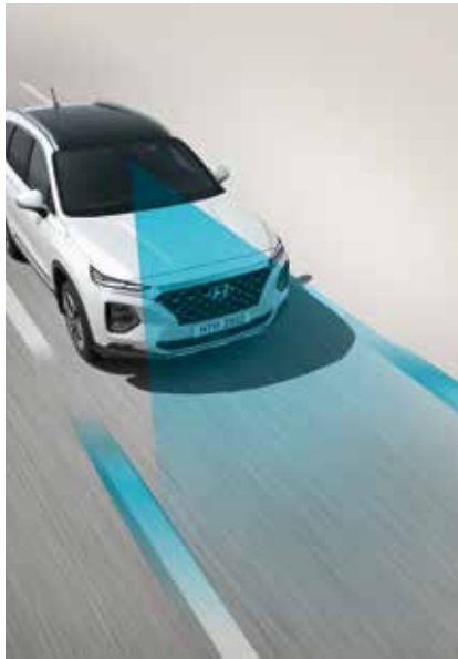
Filhållningsassistans (LKA) varnar om föraren byter fil utan att blinka i hastigheter över 60 km/h, med hjälp av ljud, symbol och slutligen även korrigering av styrhjälpen. Filhållningsassistansen kan ställas in i tre olika lägen - endast varning, mild styrhjälp eller aktiv styrhjälp.
