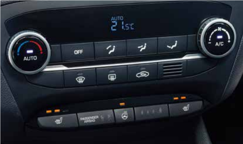
Automatisk, elektroniskt styrd klimatanläggning.
