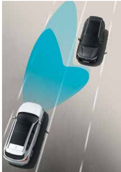
Helljusassistenten (HBA) bländar automatiskt av och på mellan hel- och halvljus, för säkrare körning nattetid.
