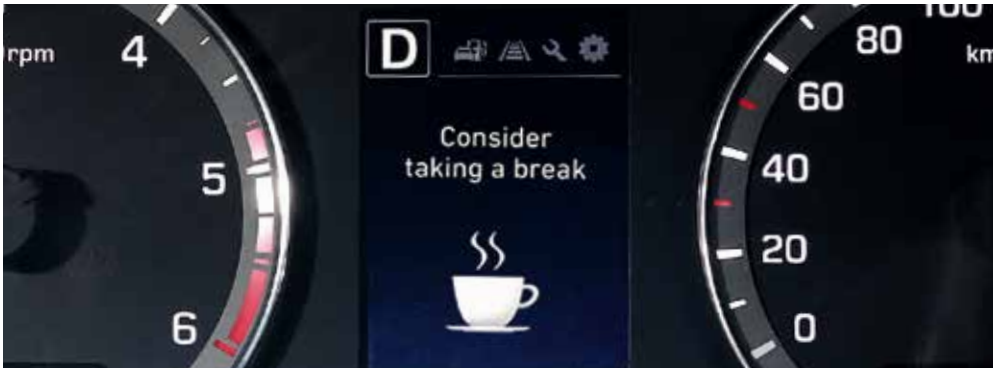
Trötthetsvarnaren (DAW) analyserar bland annat styrningen, hur bilen ligger i körfältet och körtiden. Den kan upptäcka om förarens uppmärksamhet börjar brista och varnar då med hjälp av ljudsignal och symbol i displayen.
