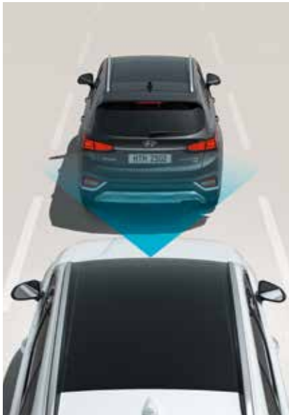
Autobromsen (FCA) känner av vägen framför bilen med hjälp av en multifunktionell kamera. Först varnar den med hjälp av ljudsignal och symboler, därefter hjälper den till med inbromsningen med full bromsverkan för att mildra eller undvika kollision. Systemet är aktivt i hastigheter över 10 km/h när ett annat fordon detekterats framför bilen.
