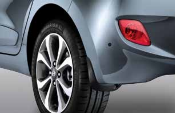
Stänkskydd bak Skyddar bilens underrede, trösklar och dörrar från smuts och grus. Modellanpassade. B9F46AK100
