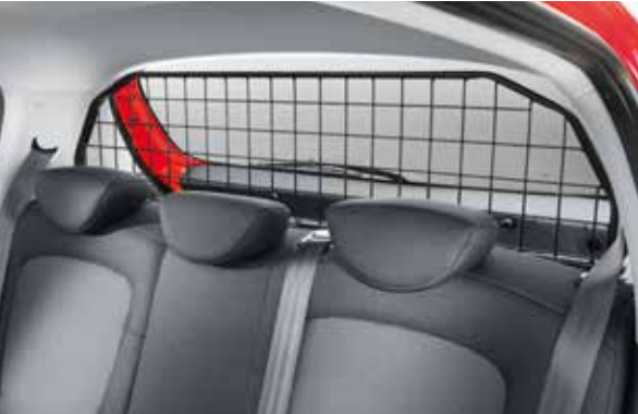
Lastgaller, övre del Gallret skiljer säkert passagerare från lasten i bagagerummet. Utformat för att ge optimal sikt bakåt. Mycket lätt att installera och ta bort. B9151ADE00
