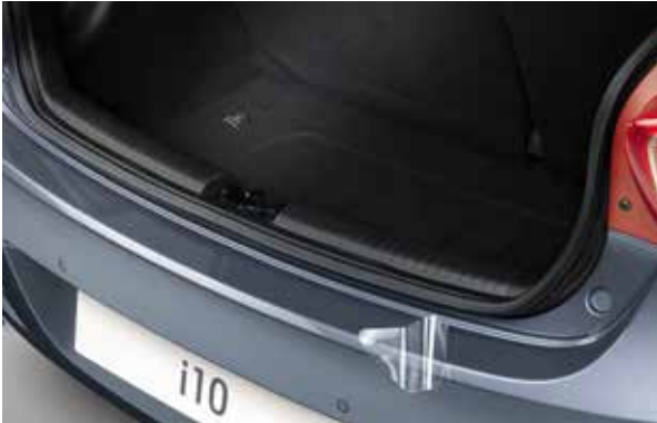
Lastskydd för bakre stötfångare, transparent. Skräddarsydd skyddsfolie för den övre ytan av bakre stötfångare. Förhindrar lackskador under inlastning och urlastning. Självhäftande. B9272ADE10TR
