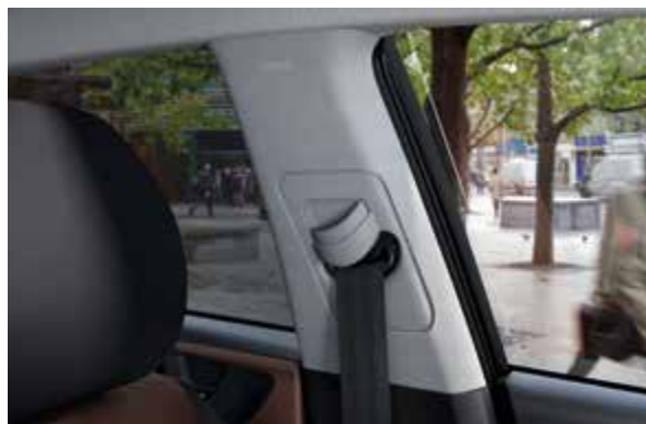
Justerbara bilbälten. De övre bältesinfästningarna fram är justerbara i höjdlöd för ökad säkerhet och bättre komfort. Ingår i Premium-paketet.
