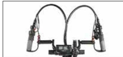
Nuova elettronica con 3 livelli di assistenza + modalità E. Sensore del freno di interruzione dell'alimentazione.
