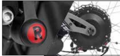
Motore brushless ad alta coppia da 300 RPM e 1440 W con retromarcia che consente una velocità massima di 30 km/h.
