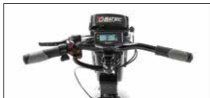
Manubrio per emiplegici in opzione freno a sinistra o a destra.
