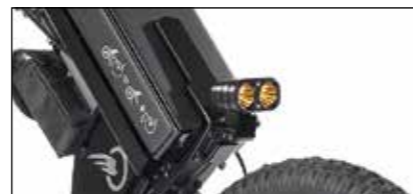
Doppio faro da 2000 lumens per luci di posizione e abbaglianti. Lente gialla per effetto Retro.
