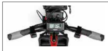
Manubrio G&B in opzione con meccanismo di guida per tetraplegici.
