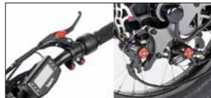
Disco freno Galfer 203 mm flottante con particolari anodizzati color rosso. Freno di parcheggio e sensore cut-off.
