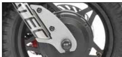
Staffa rimovibile per sostituire facilmente la camera d'aria e/o il pneumatico.
