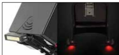
Luce anteriore da 100 lumen con luce di posizione / anabbagliate. Doppie luci di coda a LED montate sul cavalletto.
