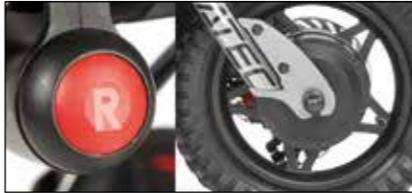
Motore brushless da 350 W e 600 W di picco. Velocità massima di 20 km/h.
