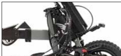
Sistema di piega per il trasporto. Telaio regolabile nelle 3 direzioni, per adattarsi ad ogni utente.
