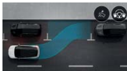
parkeringsassistent. Identifiserer og måler parkeringsplassen, og utfører manøveren automatisk. Du trenger bare regulere farten.
