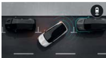
parkeringssensorer bak. Sensorene hjelper deg til å manøvrere bilen ved å gi hørbare og visuelle signaler om nærhet til hindringer bak deg.
