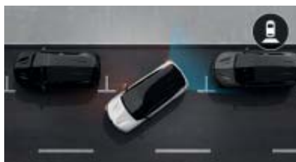
ryggekamera. Overfører et bilde av området bak bilen til skjermen når du setter bilen i revers. Hjelpelinjene gjør det enklere og tryggere å manøvrere.
