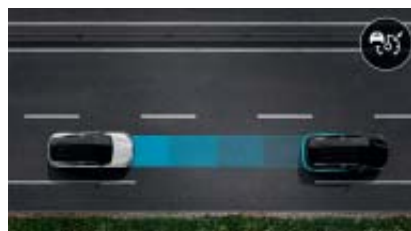
intelligent adaptiv cruise control. I tillegg til cruise control-funksjonen registreres også andre parametere for å regulere hastigheten som nødvendig.
