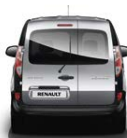
Asymmetriske bakdører med vindu, vindusvisker og varmetråder
