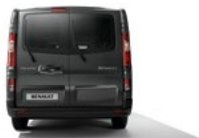
Bakdører med vinduer, 180/270° åpningsvinkel
