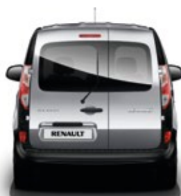
Asymmetriske bakdører med vindu, vindusvisker og varmetråder
