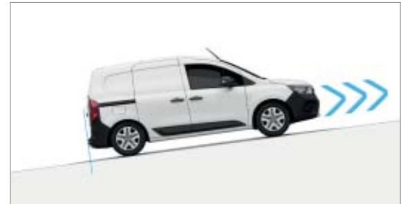
**bakkestartassistent.** Kombinert med ESP opprettholder bakkestartassistenten bremsetrykket automatisk i to sekunder. Det gir deg tid til å løfte foten fra bremsepedalen og trå inn gasspedalen. Systemet aktiveres når helningen overstiger 3 %.
