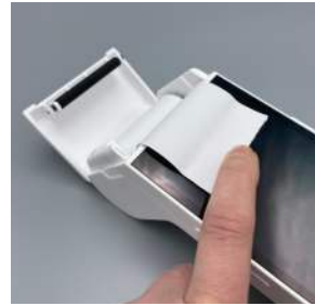
3. Vedä paperia ulos (5cm.) kunnes se työntyy ulos päätteen yläosan uran kautta.
