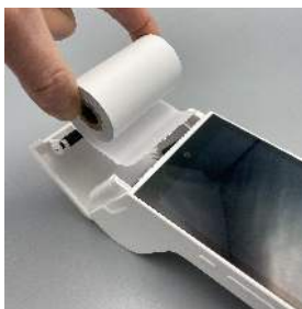
2. Sätt i pappersrullen i facket enligt anvisningarna på bilden.
